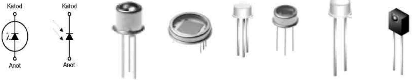
Şekil-3.25 Foto-Diyot’un şematik gösterimleri ve görüntüleri
